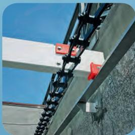
Rücklaufschiene GFR-Balken mit Gleitschuhen
